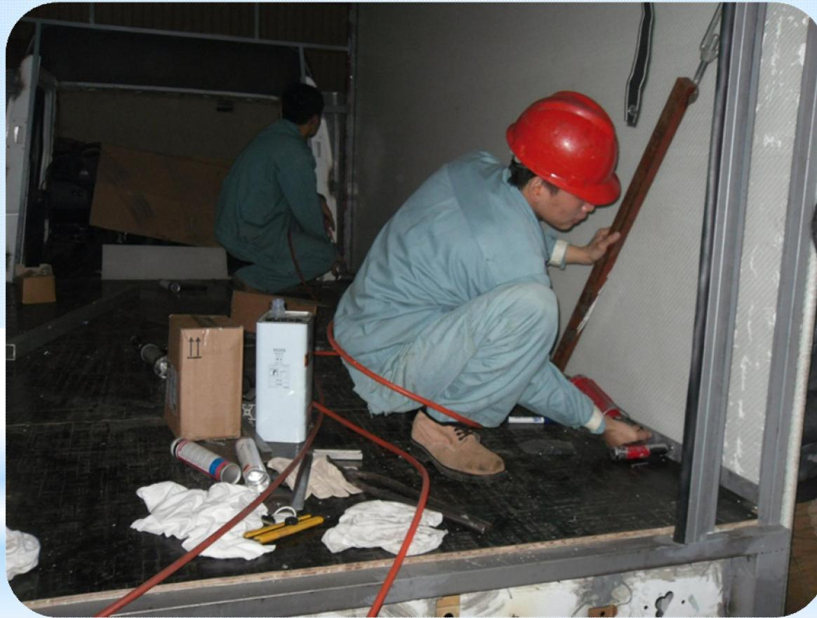
\* 安装烫好凹边的车厢门两侧挡板
