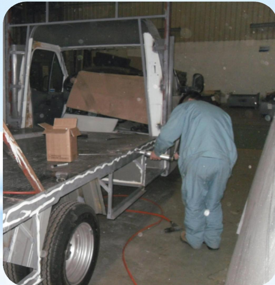
\* 将烫好凸边的两侧板上架固定，并用夹具将板材夹于车架上。
