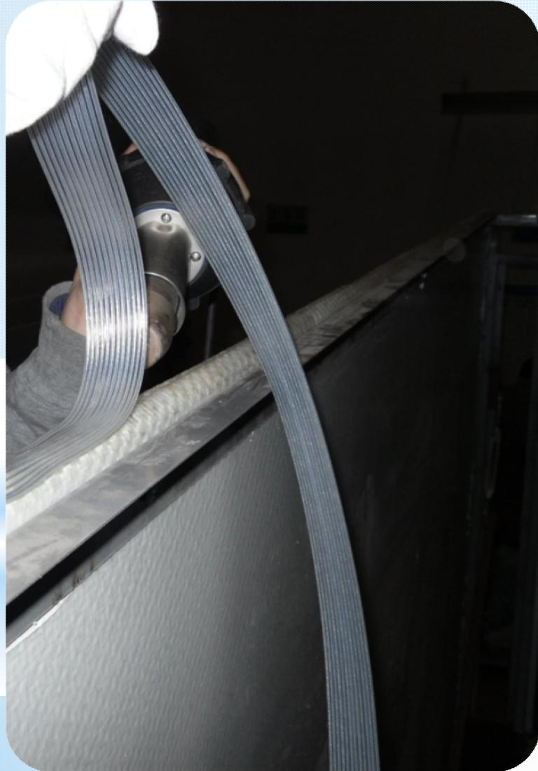
将焊枪热风吹在电热丝带和板材边之间，匀速移动，使电热丝带的PP胶衣略微熔化后贴于Holypa上
